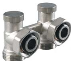
Zawór dwururowy przyłączeniowy GW 3/4" / GZ 3/4" kątowy lub prosty. Rozstaw podłączenia 50mm.
