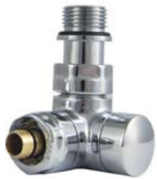
Zawór odcinający Vision. GZ 1/2" / GZ M22x1,5 lub PEX (16x2)/Cu(15x1). Do ceny zaworu nie wchodzi złączki.
