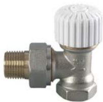
Zawór termostatyczny SF kątowy lub prosty z nastawą wstępną, gwint montażowy M30x1,5. GW 1/2" / GZ 1/2"
