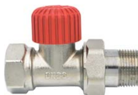
Zawór termostatyczny FP 20 prosty bez nastawy wstępnej, gwint montażowy M30x1,5. kątowny lub prosty. Wersja ekonomiczna. GW 3/4" / GZ 3/4"
