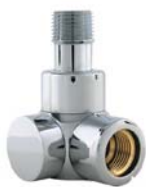
Zawór odcinający Lux 1. GZ 1/2" / GW 1/2" lub PEX (16x2)/Cu(15x1). Do ceny zaworu nie wchodzi złączki.
