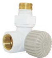
Zawór termostatyczny Master trójosiowy prawy lub lewy, gwint montażowy głowicy M30x1,5. GZ 1/2" / GW 1/2"
