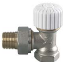
Zawór termostatyczny EF kątowny lub prosty (ekonomiczny bez nastawy wstępnej), gwint montażowy M30x1,5. GW 1/2" / GZ 1/2"
