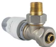
Zawór termostatyczny prosty lub kątowny (z nastawą wstępną) z wyjściem na adaptery PEX/Cu. GZ 1/2" x GZ 3/4". Do ceny zaworu nie wchodzi złączka PEX/Cu.
